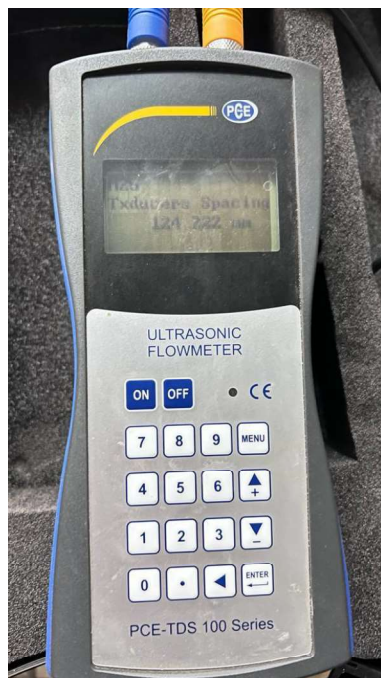
Figura 2-25. Vista general del medidor de caudales ultrasónico PCE
